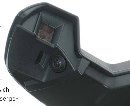
Aussenkameras ersetzen den Rückspiegel.
