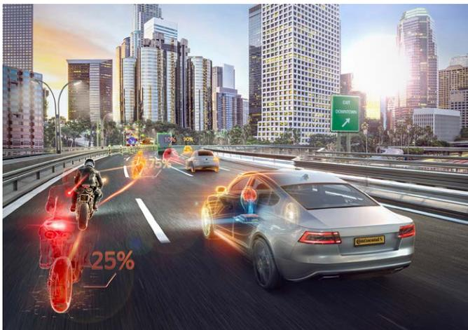
Teilautonome Fahrsysteme (SAE-Level 3) wie der Autobahn-Stauassistent bis 60 km/h müssen komplexe Fahrsituationen erkennen und auch vorausberechnen können, um korrekt zu handeln. Quelle: Continental
