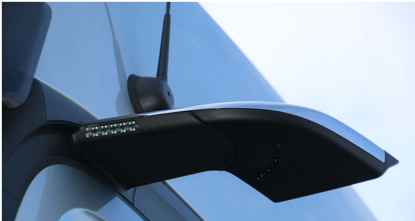
Die MirrorCam ersetzt wahlweise die herkömmlichen Aussenspiegel.
