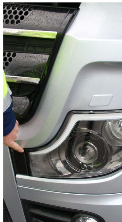
Die neue Dimension von Sehen und Gesehenwerden: LED-Tagfahrlicht, Bi-Xenon Schweinwerfer und Halogen-Nebelscheinwerfer.
