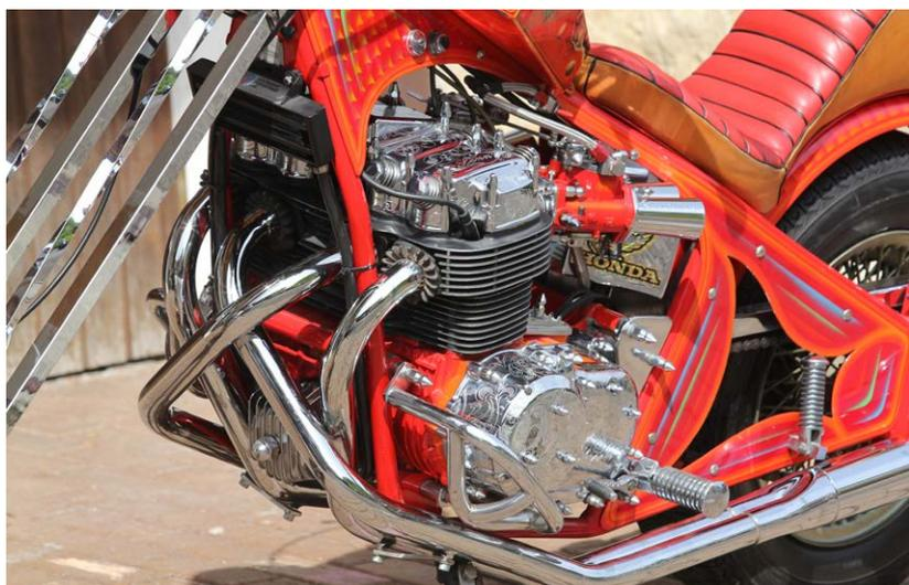
Blockmotor soweit im Originalzustand, versehen mit einem Ölkühler.
