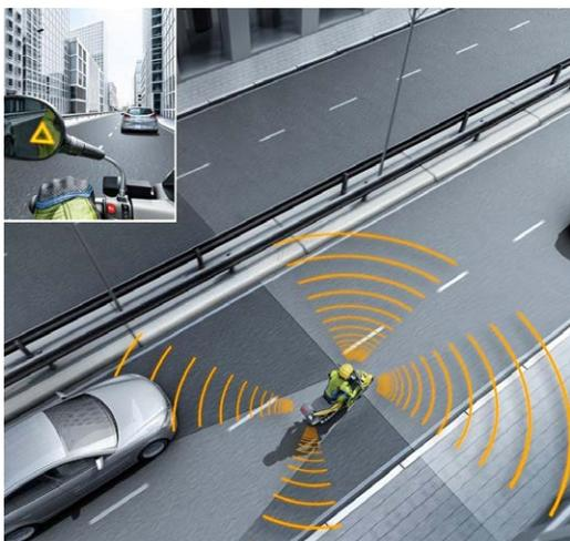
Der Totwinkel-Assistent unterstützt beim Spurwechsel.
