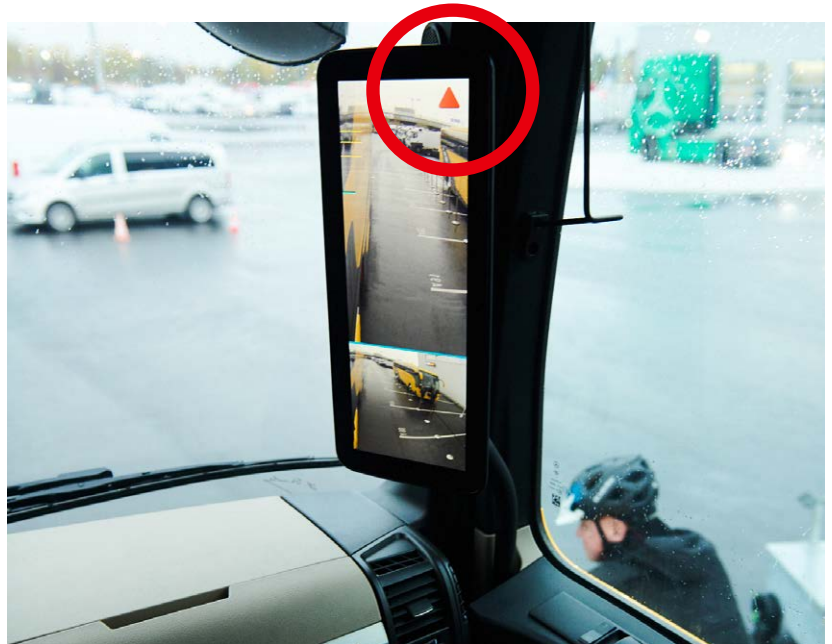
Auf dem Bildschirm ist der Fahrradfahrer nicht zu sehen. Jedoch zeigt das rote Warn-dreieck dem Fahrer eine Gefahr an.
