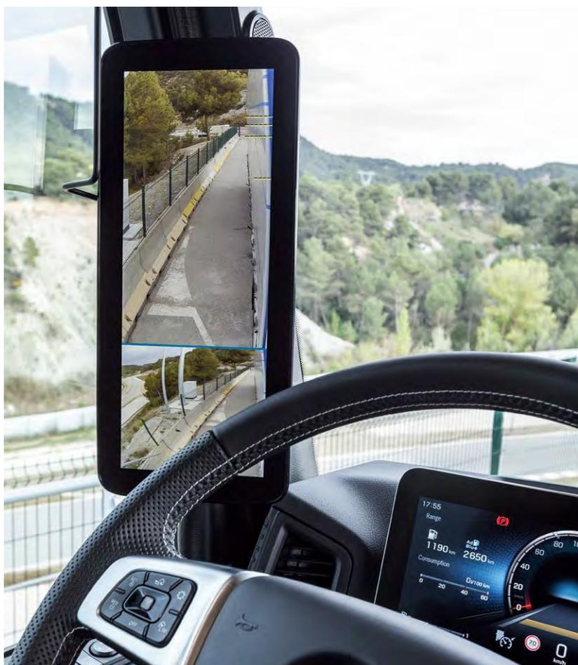
Die MirrorCam überträgt das Bild auf das Display in der A-Säule.
