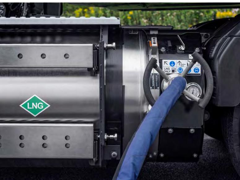
Betanken eines LKW mit Erdgas (LNG).
