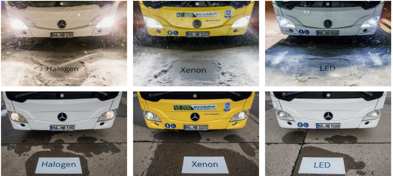
werfer in Reisebussen bei gleichem Einstellwinkel aufgrund der höheren Anbringung grösser aus als in Stadtbussen: ein wesentliches Plus aufgrund der generell deutlich höheren Geschwindigkeiten.
