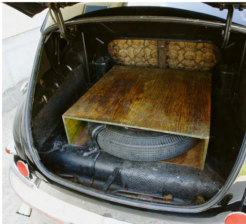
Das Ersatzrad ist in einer Holzkiste untergebracht, der Rest des Kofferraums muss ohne Verkleidung auskommen.
