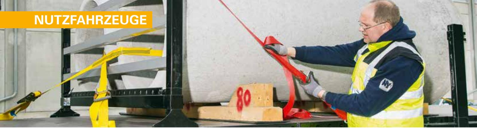
zeugen möglich. Praxisgerechte Details: Multi Lash kann bei Nichtgebrauch in das Aussenrahmenprofil geklappt werden und ist auch bei geschlossenen Bordwänden immer zugänglich. Für den Einsatz von Einsteckungen sind je Seite zehn Einstecktaschen im Aussenrahmen sowie zusätzlich zehn Taschen mittig im Boden und vier zusätzliche Rungentaschen im Halsbereich positioniert. Das Rungendepot bietet Platz für zwölf Einsteckungen von 1950 mm Länge.
