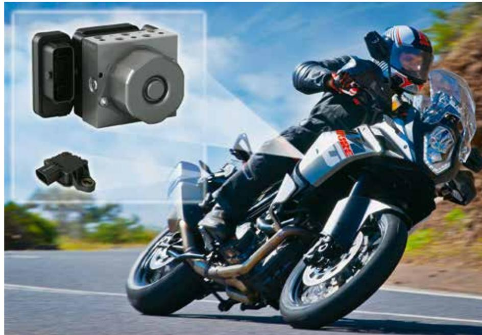
torrad bis zum ABS mit vielfältigen Zusatzfunktionen. Für sehr kostengünstige Motorräder und Roller, insbesondere in Asien, hat Bosch auch ein sogenanntes Front-ABS im Programm. Dieses 1-Kanal-ABS regelt ausschliesslich das Vorderrad, da viele der Maschinen in Asien nur dort einen hydraulischen Bremskreis besitzen. Auch diese Funktion wird Leben retten: Allein in Indien sterben jedes Jahr 40000 Menschen bei Unfällen mit dem Motorrad.
