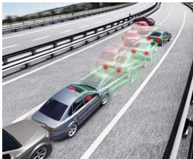
Secondary Collision Mitigation (SCM) löst nach einem ersten Aufprall eine automatische Notbremsung aus, so dass Folgekollisionen ganz verhindert oder gemildert werden. Bilder: Bosch
