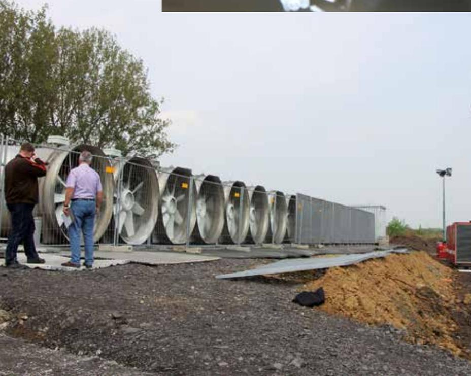
Mannshöhe Windturbinen simulieren einen kräftigen Seitenwind auf dem Testgelände.
